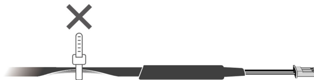
図6 結束バンドを締めすぎない
